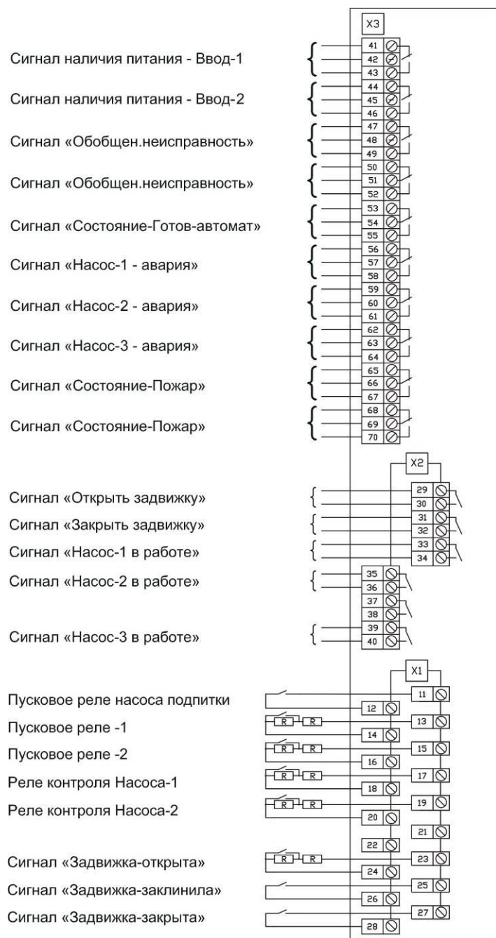
Рис.4 Схема подключения сигнальных цепей (X1, X2, X3)
